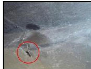
No se aceptarán deterioros por corrosión que traspasen la capa de laca o de pintura.
