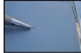
**Capo y techo.- hasta 3 impactos de diámetro máximo 2 mm.**
