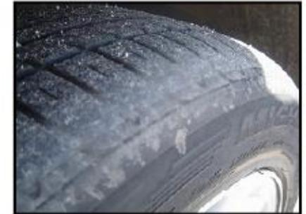
*Un neumático con desgaste irregular de las superficies de rodadura (formación de dientes de sierra).*
