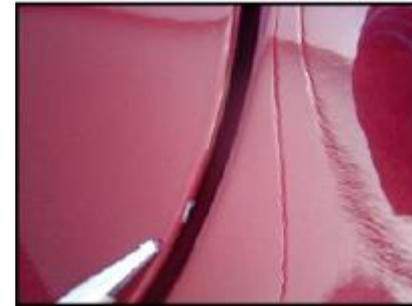
Una abolladura especular de menos de 10 mm de diámetro aceptando 2 por pieza y que no requiera pintura, visibles a 45°
