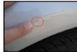
**Resto de carrocería.- hasta 3 impactos de diámetro máximo 3 mm**
