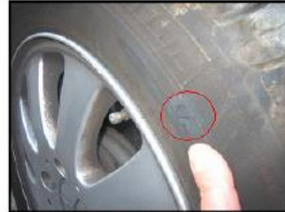
*Un neumático con cortes o desprendimientos en las bandas laterales.*
