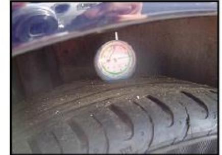
*Los neumáticos con una profundidad de dibujo residual inferior a 3 mm. (incluida la rueda de repuesto) han de ser sustituidos*
